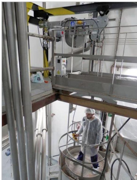
APLICACIÓN DEL EQUIPO DE DESCENSO AVAHO-S CON CESTA CIRCULAR Ø1 m EN TOLVA INDUSTRIAL
