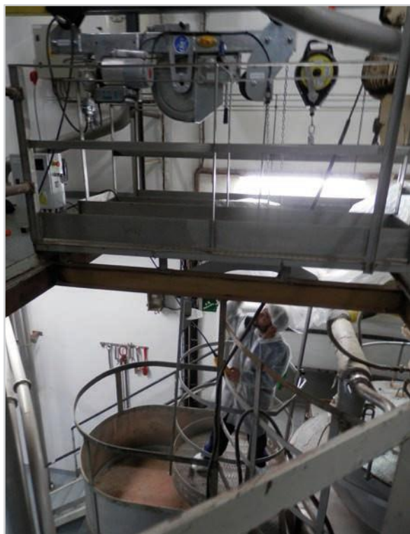
APLICACIÓN DEL EQUIPO DE DESCENSO AVAHO-S CON CESTA CIRCULAR Ø1 m EN TOLVA INDUSTRIAL
